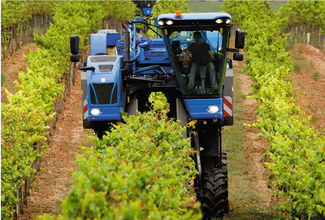
Fig. 1. Vendimiadora en forma de túnel, que utiliza diversos sistemas de sensores y actuadores de alta precisión, por ejemplo, para: (a) equilibrar alturas de los sacudidores, (b) seguimiento del avance frontal escaneando las hileras de los viñedos, (c) auto nivelar la inclinación de la maquinaria según el terreno irregular y respecto a las toneladas de uva desgranada que lleva almacenada en la tolva, (d) células fotoeléctricas para eliminar hojas y trozos de sarmientos. Así mismo, el operador se encuentra en una cabina conectada y presurizada a menos de 66 dB para controlar el cumplimiento de diversos parámetros: porcentaje de la merma aceptable, dirección y velocidad de recolección, cantidad de sacudidores, frecuencia de vibración, revoluciones de los ventiladores de limpieza, entre otros. [From New Holland. “GAMA DE ALTA CAPACIDAD BRAUD”. En New Holland Agriculture. https://agriculture.newholland.com/es-es/europe/productos/vendimiadoras/gama-de-alta-capacidad-braud ].
