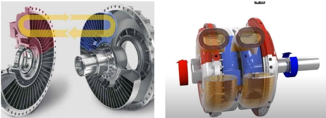
En la figura de la izquierda la bomba y la turbina. En la derecha ambas ruedas cerradas y dentro de un cubículo con relleno del fluido (aceite)
