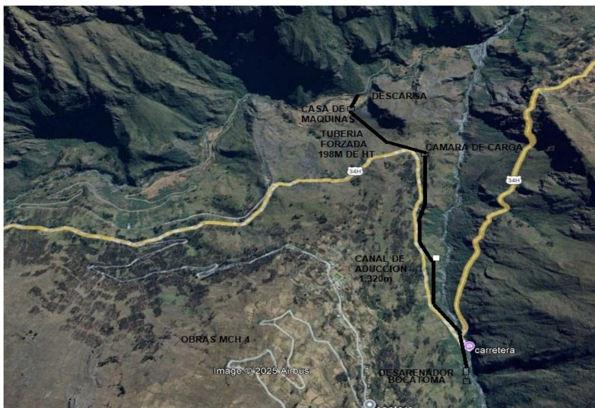
Figura 7 - Obras de la MCH 4, con las dimensiones básicas identificadas en el aprovechamiento
